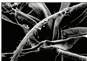
Figure 4 : Fibres de coton rincées à l'eau (microscope électronique à balayage - agrandissement 700 x) Water rinsed polycotton fibres (scanning electronic microscope 700 x magnification)
